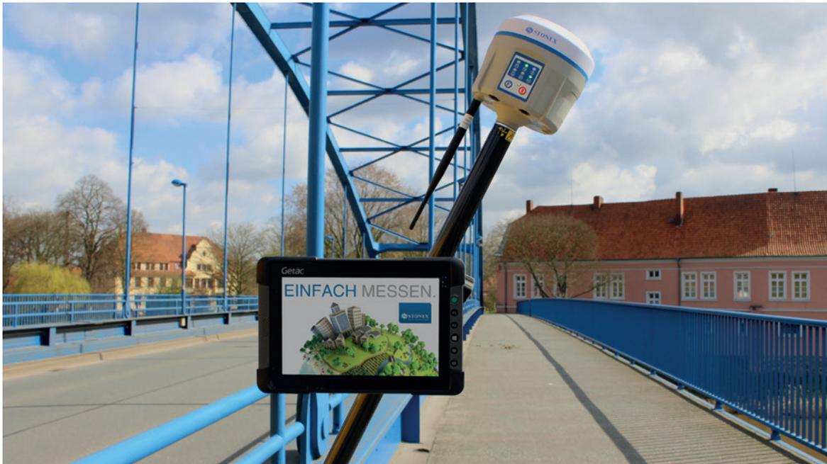
Stonex S10 mit Inertialsystem im Einsatz
