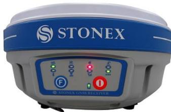
Fig. 2.1 - S9III PLUS mainframe
