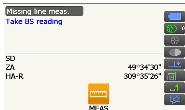
3. Visieren Sie das Ziel an und drücken Sie **[MLM]**, um die Messung auszulösen. Drücken Sie **[STOP]**, um den Messvorgang zu stoppen.
